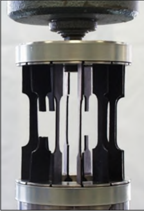
(a) Pulsationsmaschine mit Proben Spannungsermittlungen durch Simulation (b)
